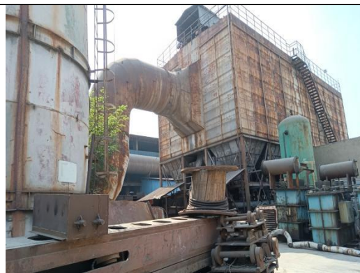
熔炼工序旋风+布袋除尘器
